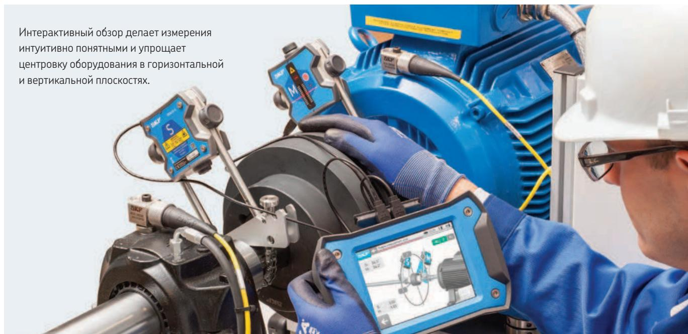
Передовая лазерная система выверки соосности валов с улучшенными характеристиками измерения и возможностью создания отчётов
