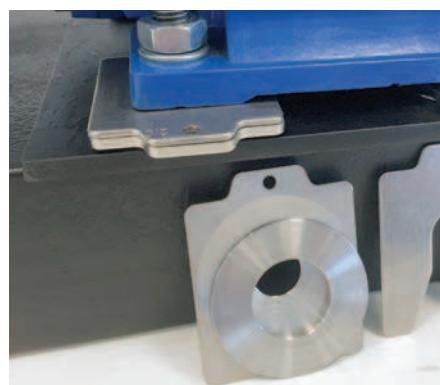
Пластины для коррекции угловой расцентровки
